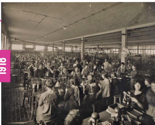
Usine de matériel de guerre. Terminaison des pièces de la fusée de 75. BML. Res 151075 Numelyo
